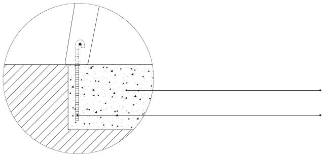
maciço em cimento . concrete . massif en béton
