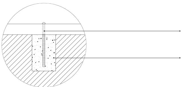
parafuso em inox . stainless steel screw . vis en inox
